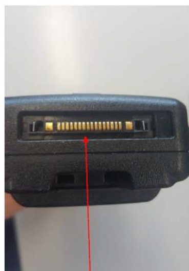
ZONA DE PINS DE CARGA Y CONEXIÓN
