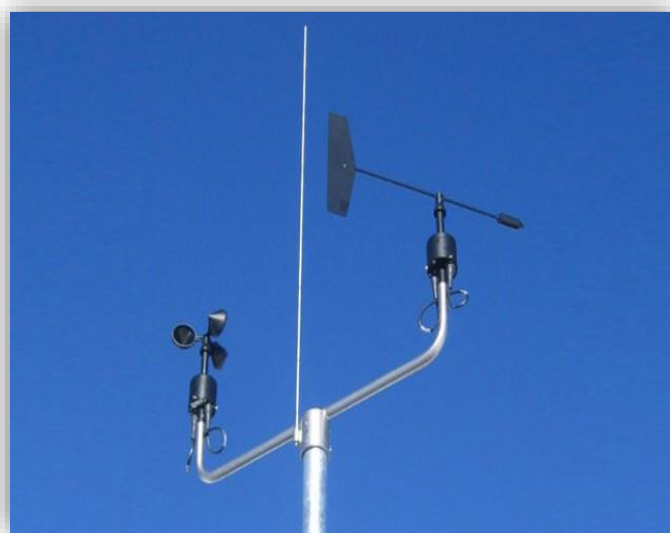
IMAGEN 3. Anemómetro de cazoletas y veleta.
