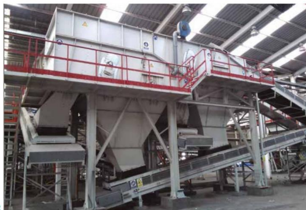
2. Separador balístico de rebote en dos planos.
