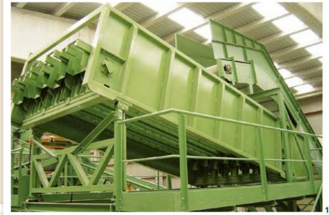
1. Separador balístico de rebote en un plano.
