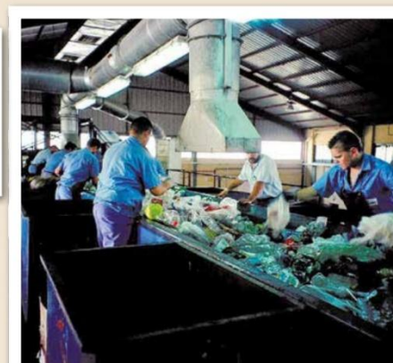
5. Aspiración semiautomática en cabina de triaje secundario.
