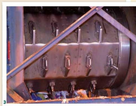
3. Abre-bolsas tipo desgarrador.
