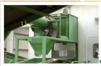
7. Sistema de separación mediante paso de corriente a través de malla circular giratoria.
